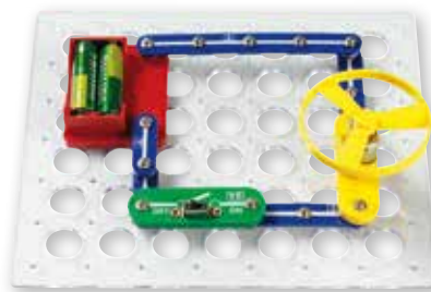
Experiment: Strom erzeugt Bewegung
