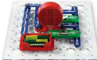
Experiment: Türklingel mit Druckschalter
