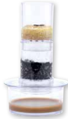
minimaler zweistufiger Filter mit Sand und Aktivkohle
